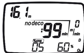
Указатель выбранной смеси мигает, подтверждая, что принят введенный номер. Затем Nemo Wide автоматически вернется к экрану текущей фазы погружения, но будет отображать информацию deco/no-deco, пересчитанную для используемой в данный момент смеси.
